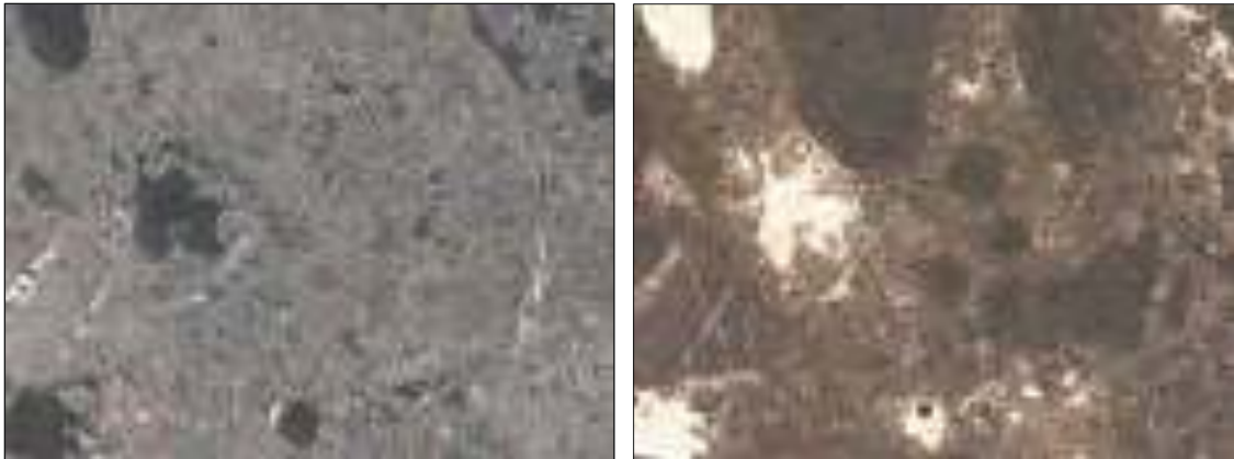
Sl. 7.2: Mikroskopski posnetek vzorca malte (V – 170/18), \times 50 . Levo: presevna svetloba, navzkrižni nikoli. Desno: presevna svetloba, vzporedni nikoli (foto: S. Kramar)
