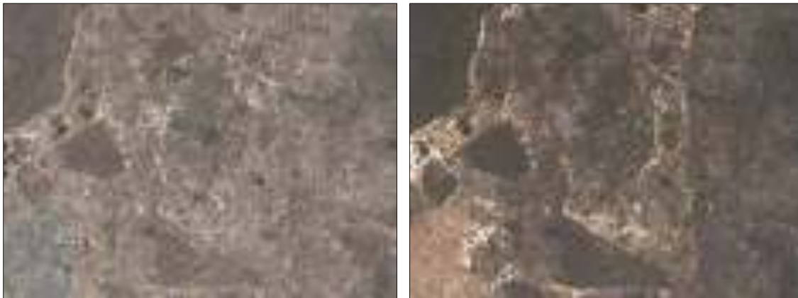
Sl. 7.7: Mikroskopski posnetek vzorca malte (V – 189/18), \times 50 . Levo: presečna svetloba, navzkrižni nikoli. Desno: presečna svetloba, vzporedni nikoli (foto: S. Kramar)
