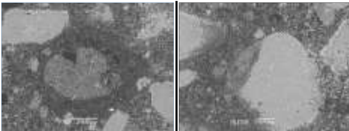
Sl. 7.4: SEM/BSE posnetek vzorca malte (V – 170/18). Zrno keramike z reakcijskim robom (levo) ter spremenjeni robovi dolomitnih zrn (desno) (foto: S. Kramar)
