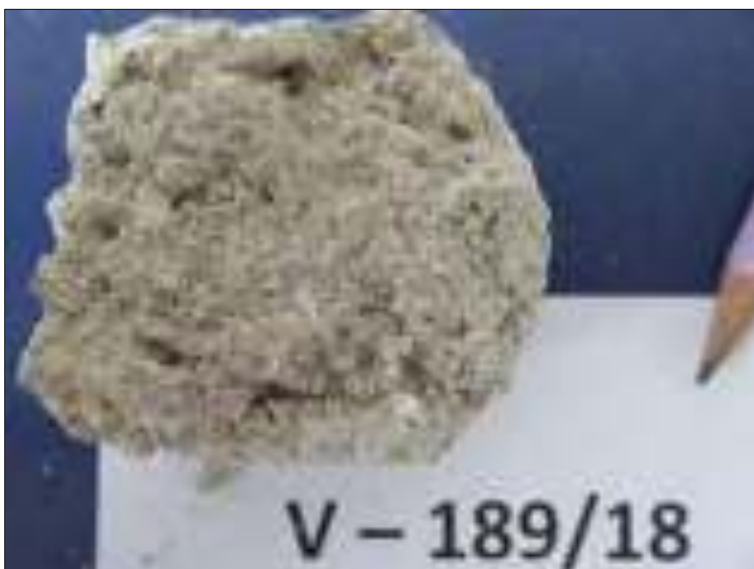
Sl. 7.6: Makroskopski posnetek vzorca ometa (V – 189/18) (foto: K. Šter)
